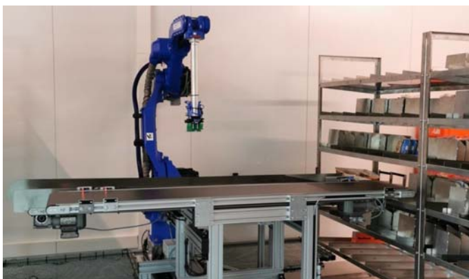
Der Roboter sammelt die bestellten Waren im Kühlraum ein und bringt die zur Warenausgabe. © Foto: Laura Liboschik
